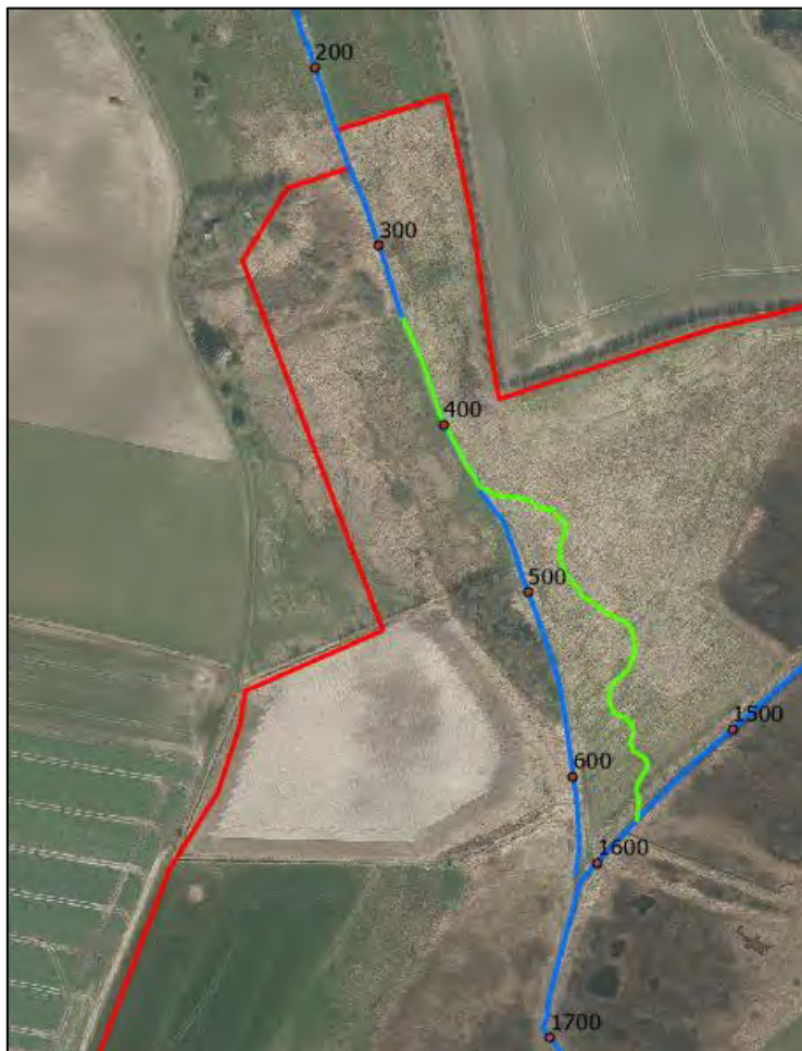
Figur 4-4 Oversigtskort der viser Irup Bæk nuværende forløb (mørkeblå linje), det projekterede forløb af Irup Bæk (lysegrøn) samt projektområdet (rød). Luftfoto hentet fra Geodatastyrelsen juli 2021.
